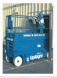
Mit den schnell einklappbaren Sicherheitageländern und mit einer Breite von nur 25 mm paßt die X26 Ultra-N durch einfache Standardtürbreiten.
